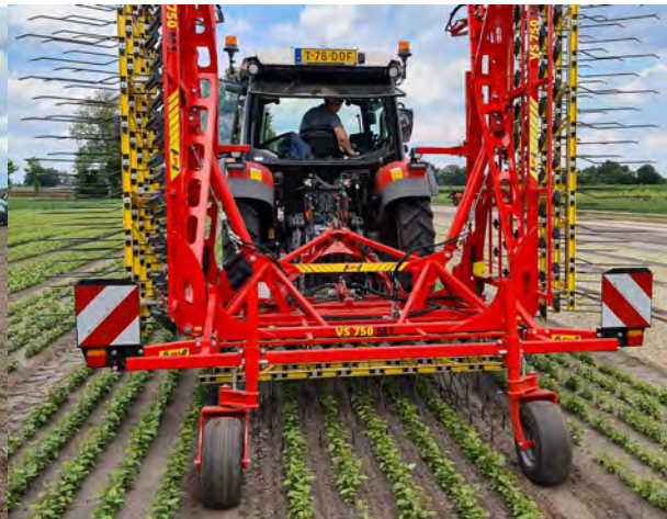
Foto 2. APV wiedege met langere tanden en een werkbreedte van 750 cm.
